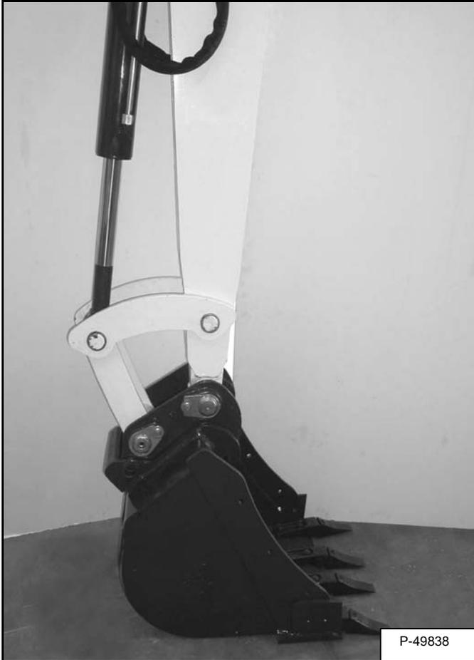
Estacione a escavadeira sobre uma superfície plana nivelada. Apoie a caçamba sobre o solo **[Figura 114]**.
