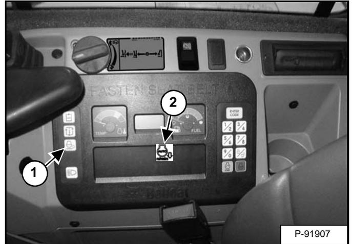
O recurso de marcha lenta automática (quando acionado) reduzirá a aceleração do motor para marcha lenta quando as alavancas de controle (joystick, lâmina, deslocamento, etc.) permanecerem em neutro e não utilizadas por aproximadamente quatro segundos. As rotações do motor retornarão à posição definida quando qualquer alavanca de controle for acionada.
