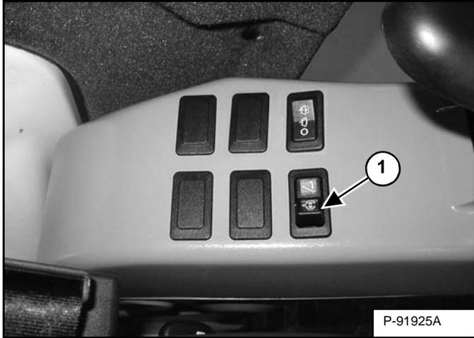
Mova o interruptor (item 1) de deslocamento da lança / hidráulicos auxiliares secundários [Figura 51] para a direita, posição hidráulica auxiliar secundária.
