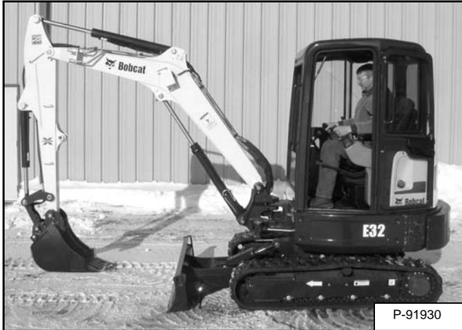
Pare a máquina em piso nivelado. Abaixue o equipamento de trabalho e a lâmina até o solo [Figura 76].
