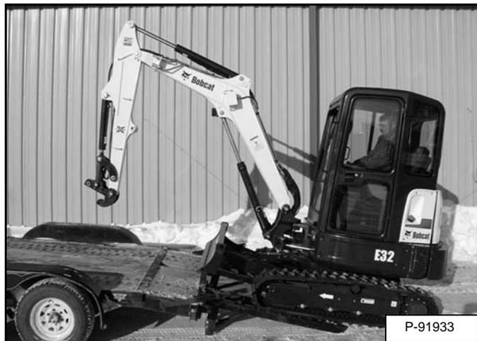
Mova a máquina para a frente sobre o veículo de transporte [Figura 145].
