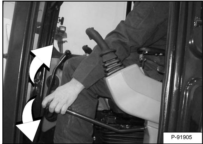
O interruptor de trava do joystick desativa as funções de controle hidráulico dos joysticks quando o console está levantado [Figura 120].
