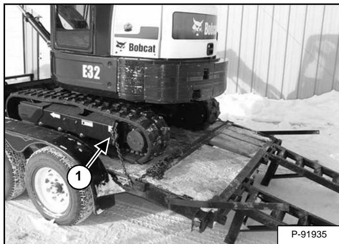
Fixe correntes aos cantos dianteiros da lâmina (item 1) [Figura 146] e aos olhais de ancoragem em ambos os lados do chassi da máquina (item 1) [Figura 147] para prevenir movimentos da máquina em subidas e descidas ou durante freadas bruscas.
