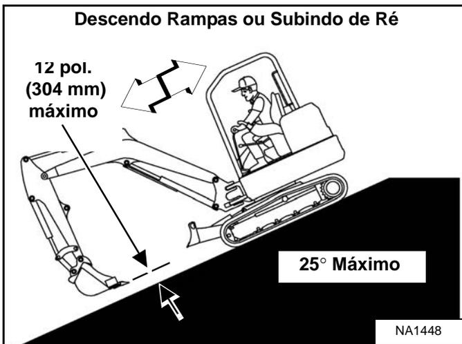
Quando descer inclinações que excedam 15 graus, coloque a máquina na posição mostrada, com o motor funcionando devagar [Figura 136].
