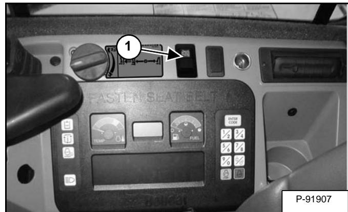
Mova levemente as alavancas de controle de deslocamento para a frente (até a máquina se mover lentamente para a frente) e pressione o interruptor de cancelamento do alarme de movimento (item 1) [Figura 152]. O alarme de movimento desligará. Com a máquina ainda se movendo para a frente, mova uma das alavancas para a posição neutra; o alarme de movimento deve soar.
