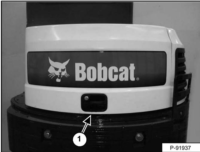
Esta máquina pode estar equipada com um sistema de alarme de movimento. O alarme de movimento (item 1) [Figura 34] está localizado dentro da parte traseira da escavadeira.
