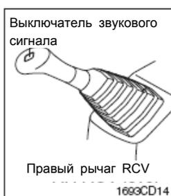
(1) Этот выключатель расположен в верхней части правого джойстика управления. При его нажатии издается звуковой сигнал
