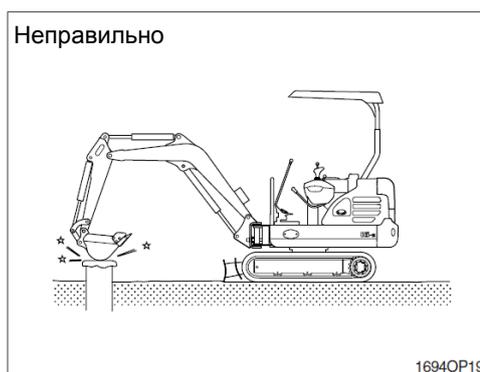
11) Не используйте ковш для разрушения твердых кусков породы, таких как бетон или камень. Это может привести к поломке зубьев, пальцев или погнуть стрелу.
